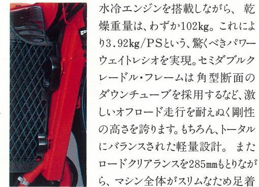
水冷エンジンを搭載しながら、乾燥重量は、わずか102kg。これにより3.92kg/PSという、驚くべきパワーウェイトレシオを実現。セミダブルクレードル・フレームは角型断面のダウンチューブを採用するなど、激しいオフロード走行を耐えぬく剛性の高さを誇ります。もちろん、トータルにバランスされた軽量設計。またロードクリアランスを285mmもとりながら、マシン全体がスリムなため足着
